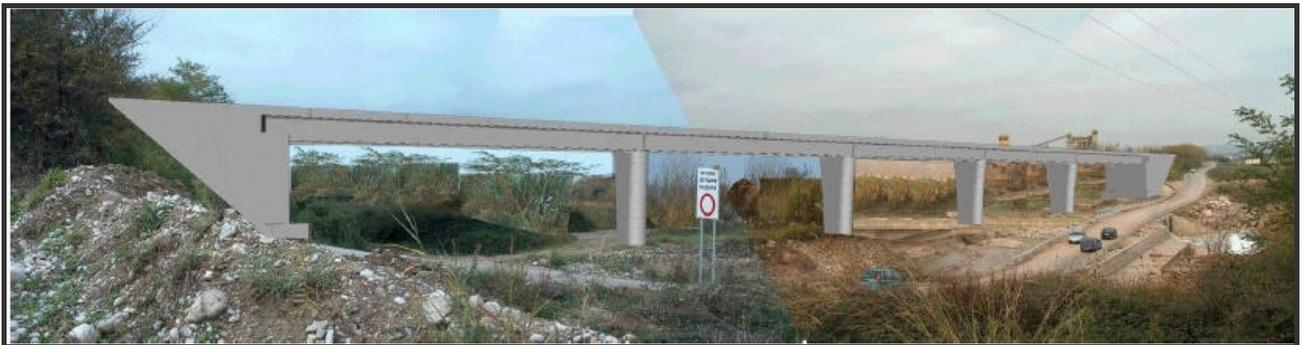
La nuova struttura, previo abbattimento del vecchio ponte, sarà di cemento armato e conterà quattro piloni. Questi ultimi, un terzo rispetto ai dodici del viadotto crollato, non dovrebbero costituire l'effetto diga e, quindi, resistere alla piena del fiume. Identica rimarrà la lunghezza, 200 metri circa, mentre la larghezza sarà di dodici metri, ossia quasi il doppio di prima.
